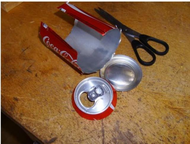
On découpe une bande d'environ 4 cm en conservant la plus grande longueur possible, puis on plie la languette en deux et on replie environ 5 mm de double tôle sur les 2 côtés.
