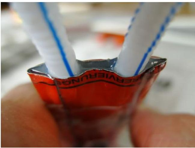
Les chalumeaux (des pailles avec soufflet que l'on peut couder) sont coupés pour ne rentrer que de 1 ou 2 cm dans la chaudière et collés à l'epoxy.
